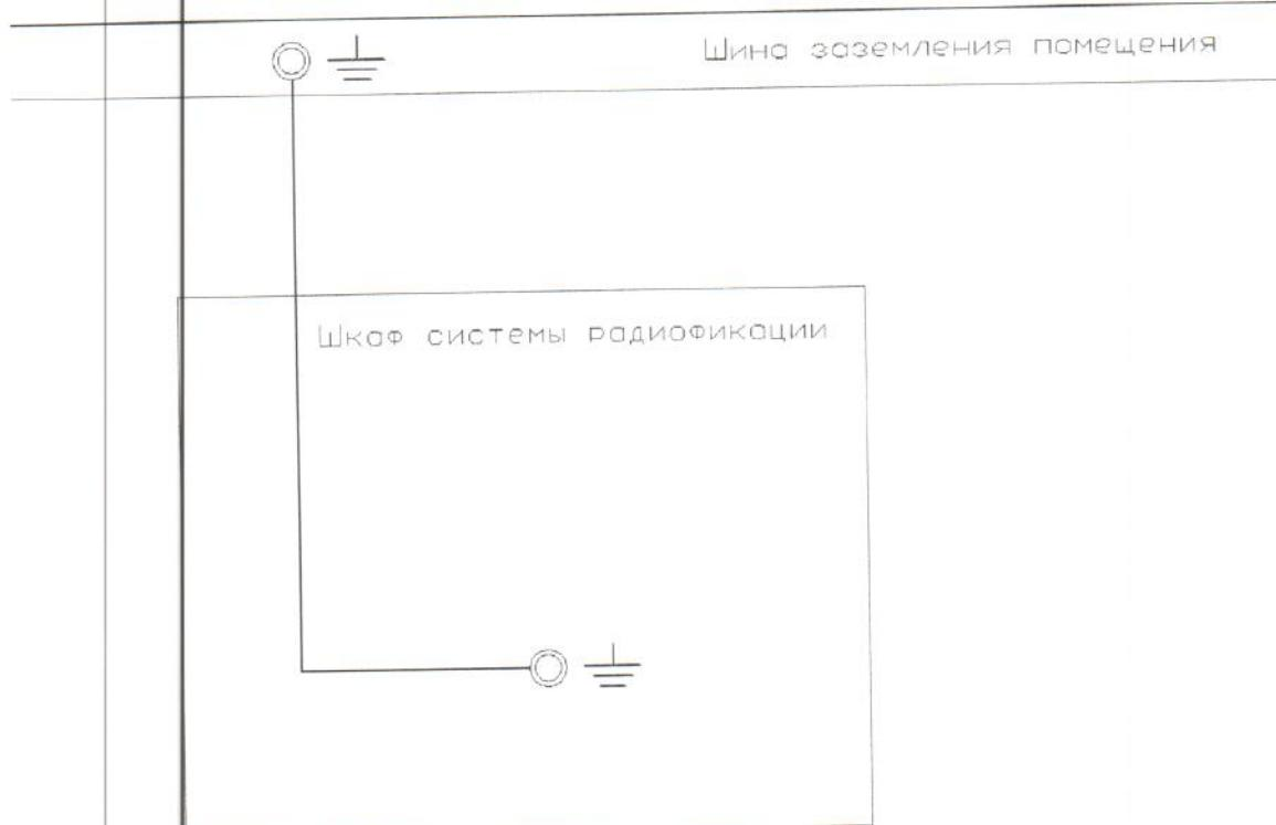
Заземление выполнено проводом Н07V-К сечением 4мм<sup>2</sup> (цвет зелено-желтый) к штатной колодке заземления РЩ и в предусмотренных точках заземления шкафов под винт (гайку).
